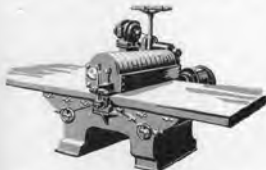
Vzor AD a příložec VA Vysokovýkonný stroj hobla- vací s převodní došou se širou 300 mm hoblovací hlí. S automatickým posuvem, příložcem.
