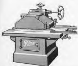
Vzor KS Automatická gila smička a příložec. S automatickým řízením posuvu. Posuv cca 50 m za minutu.
