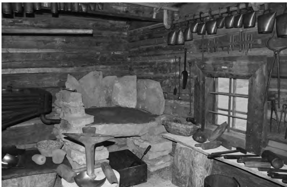
Obr. 15, 16. Novovybudované ohnisko v interiéri zvonárskej dielne a piecka na tavenie zvonoviny a mosadze, nachádzajúca sa do roku 2018 v dielni zo Zázrivej v Múzeu slovenskej dediny. Foto R. Sýkora, 2018 Fig. 15, 16. The newly-built hearth inside of the bell-making workshop and stove for melting bell metal and brass, situated until 2018 in the workshop from Zázrivá in the Museum of the Slovak Village. Photograph by R. Sýkora, 2018
