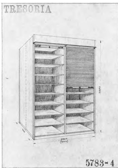
Obr. 6, 7, 8. Návrhy archivních skříní, zvislý rez A-A. „Tresoria, Továrna pokladen, akciová společnost, Praha“, 1932. Archiv SNM, pobočka v Martine. Reg. MSS, list č. 93/1932 Fig. 6, 7, 8. Designs for archive cabinets, vertical cross-section A-A. “Tresoria, Factory of chests, joint-stock company, Prague”, 1932. Archives of the SNM, Martin branch. Reg. MSS, letter no. 93/1932
