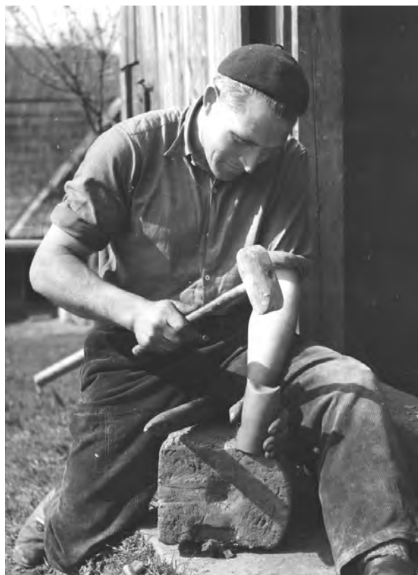
Obr. 2. Jeden z posledných zázrivských zvonkárov Jozef Pikla (*1915) pri úprave prehnutia pleca zvonca. Fotoarchív SNM v Martine, č. F-04 208.
