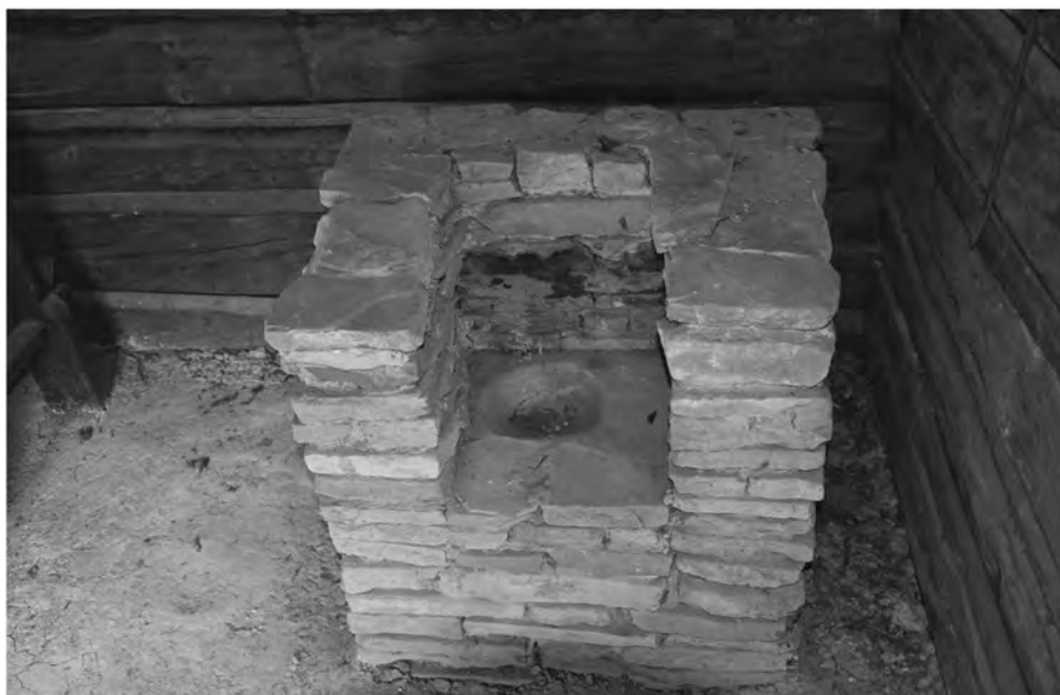
Obr. 15, 16. Novovybudované ohnisko v interiéri zvonárskej dielne a piecka na tavenie zvonoviny a mosadze, nachádzajúca sa do roku 2018 v dielni zo Zázrivej v Múzeu slovenskej dediny. Foto R. Sýkora, 2018 Fig. 15, 16. The newly-built hearth inside of the bell-making workshop and stove for melting bell metal and brass, situated until 2018 in the workshop from Zázrivá in the Museum of the Slovak Village. Photograph by R. Sýkora, 2018
